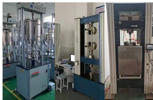
型号：高温拉伸、蠕变、三点抗弯试验机
