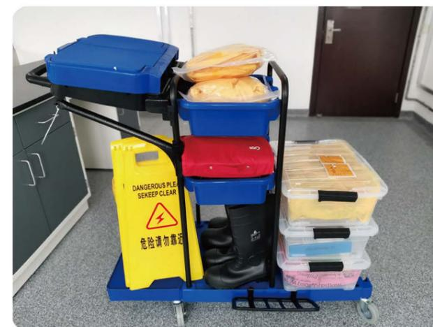
图4.2 化学品泄漏控制用品
