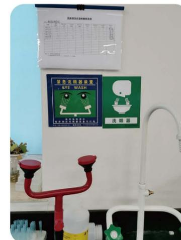
图4.3 位于洗手盆旁边的应急洗眼设备
