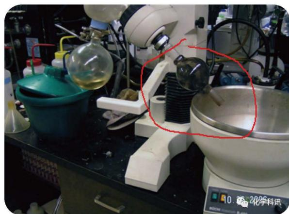
图1.4 圆底烧瓶在水浴锅内爆炸后现场照片（来源：学校事故报告）
