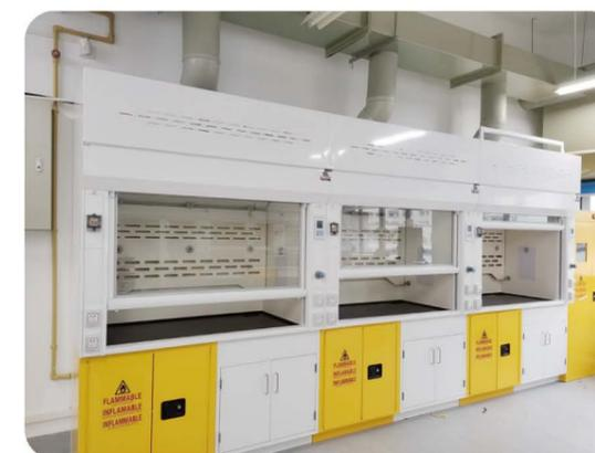
图3.11 一种专门为储存易燃物品而设计的带有底座的通风柜
