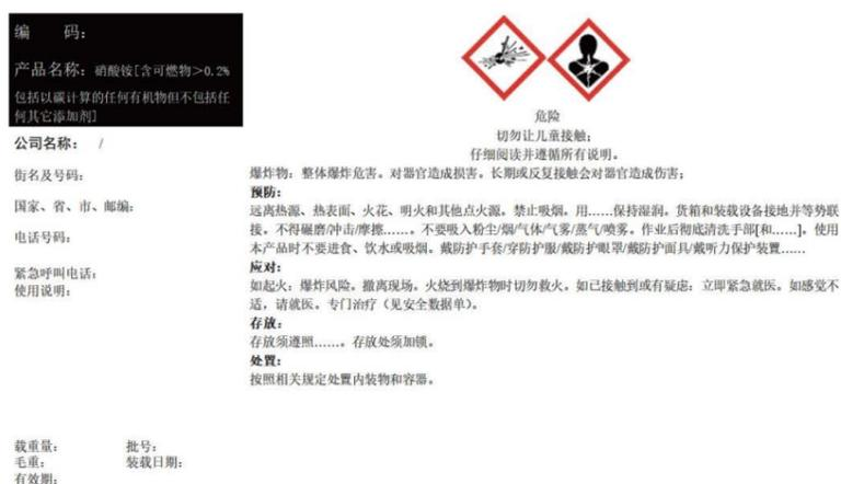
图2.2 化学品GHS标签样本（硝酸铵[含可燃物>0.2%]）
