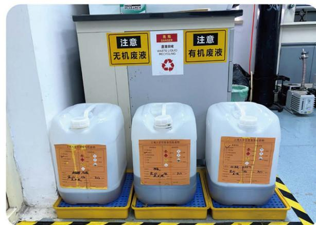
图3.15 分类储存化学废物
