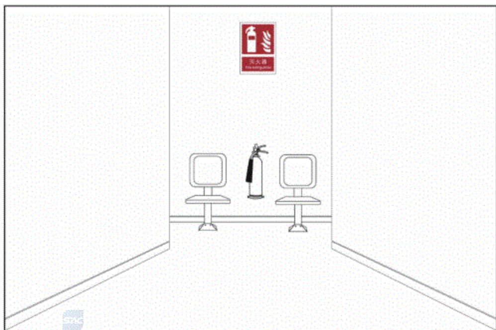
图 B.3 使用安全标志指示灭火器位置的示意
